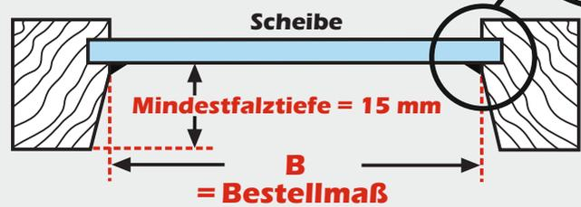
Bei einer schrägen Glasleiste messen Sie die Breite **B** so dicht an der Scheibe wie möglich aber **inklusive** Dichtung!
