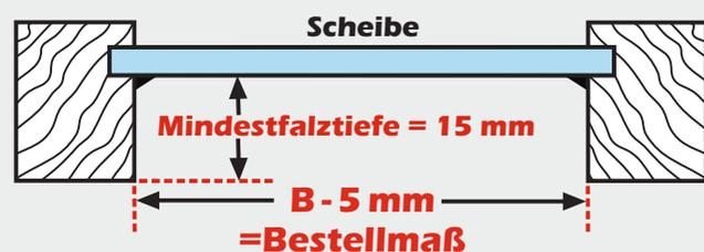
Bei einer geraden Glasleiste messen Sie die Breite **B** einfach von Falz zu Falz.
