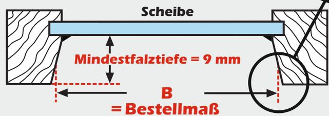
Bei einer schrägen Glasleiste messen Sie die Breite **B** **1cm** von der Vorderkante entfernt!
