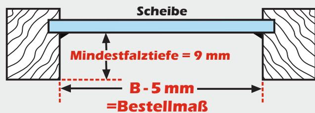
Bei einer geraden Glasleiste messen Sie die Breite **B** einfach von Falz zu Falz.
